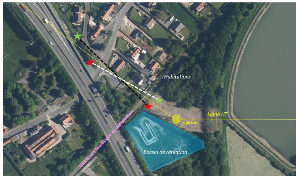
Figure 4-17 : Passage sous la voie ferrée et sous la rue de l'Europe – Solution avec un unique tronçon sans tranchée
