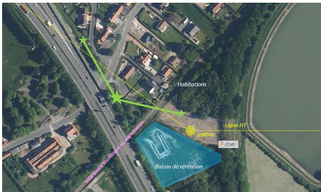
Figure 4-18 : Passage sous la voie ferrée et sous la rue de l'Europe – Solution avec deux tronçons sans tranchée
